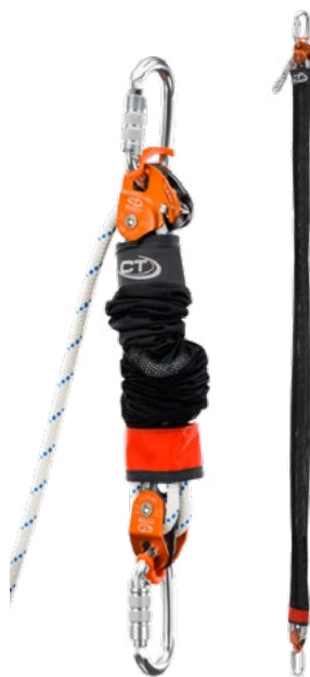
Selbstblockierender Einholflaschenzug, mit Reduktionsfaktor 4, oder 5, falls anders herum verwendet Auto-blocking rescue winch with 4x reduction factor, or 5x when used upside down
