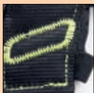
Einzelner Stich fehlt (bei Unsicherheit Hersteller kontaktieren)
