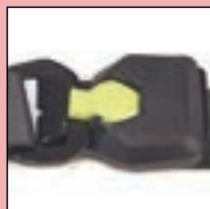
Triple Lock-Schnalle mit gebrochenem Druckknopf
