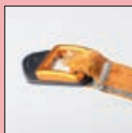
Band in der Schnalle aufgescheuert
